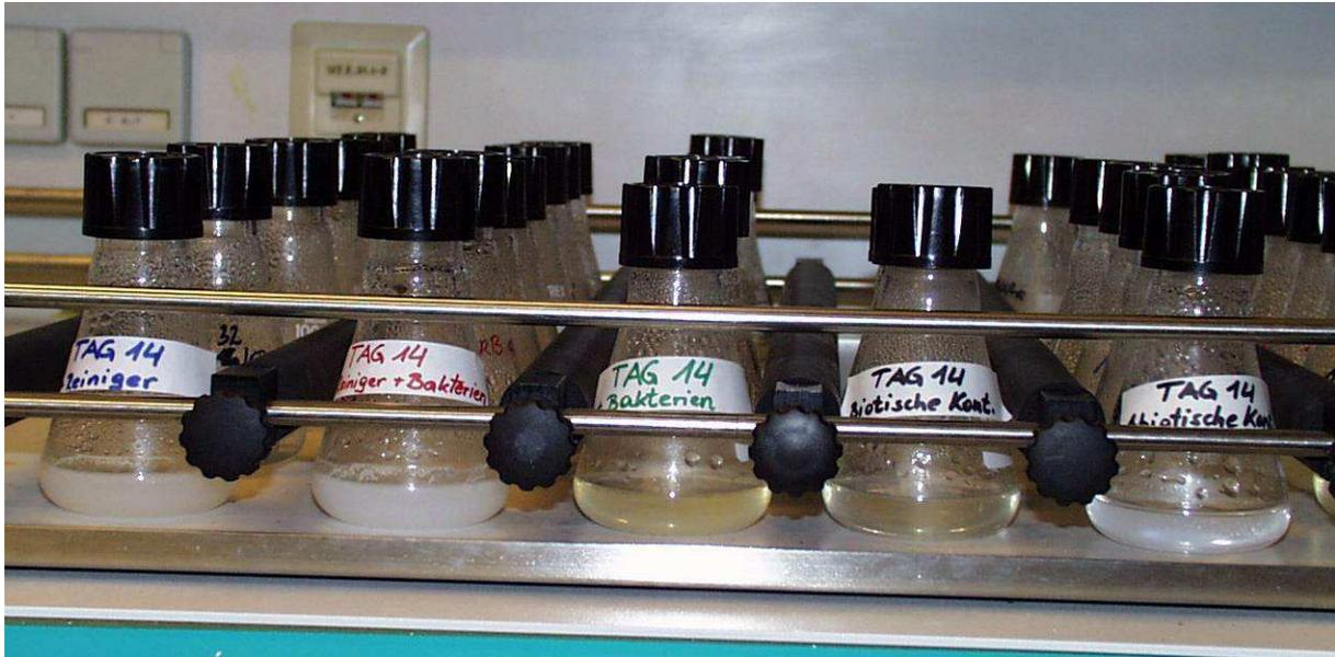
Das Foto zeigt die einzelnen Versuchsansätze (R, RB, B, KB, KA, von links nach rechts) nach 14 Tagen Inkubation mit deutlich sichtbaren Unterschieden in der Mikroorganismendichte. Stärkstes mikrobielles Wachstum und damit größter Schadstoffabbau ist für die Ansätze R (BIOthek AGUA) und RB (BIOthek AGUA + BIOthek BACTERIA) erkennbar.
